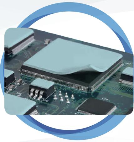
導熱墊片是一種具有良好導熱性的熱界面材料，其係用於貼合在兩種材料接觸面上的空隙。導熱墊片具方便的加工性，可應用在需要大範圍散熱以及多種高低不平表面的元件，以建立良好導熱通道。隨著對熱管理的更高要求，GTA提出了創新和優化的導熱墊片，使產品能有效改善元件間的傳熱效率，對電子設備的性能、使用壽命和穩定性起著重要作用。導熱墊片可廣泛應用於電子產品、汽車電子、電信、筆記型電腦、LED等電子產品中，也可用於任何需要熱管理解決方案的應用。
